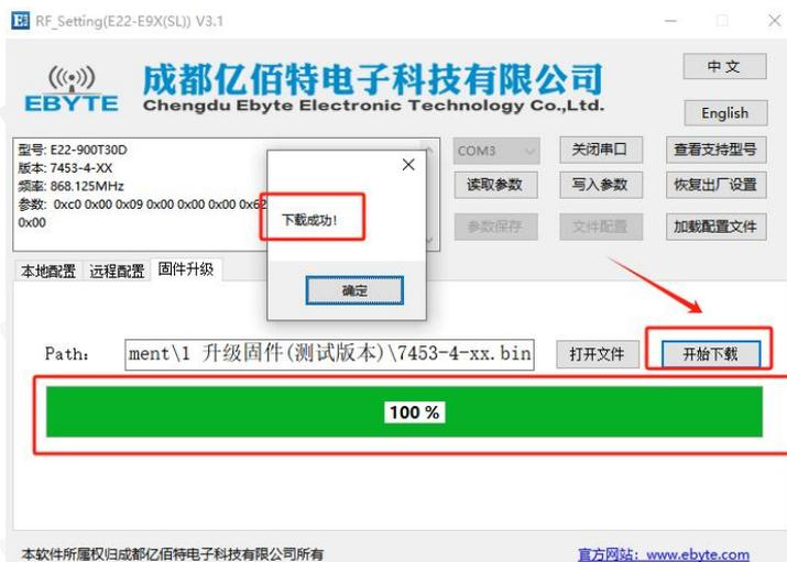
6、固件升级完成后重新打开串口确认读取参数。
